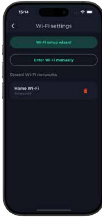
Sie können bis zu zehn verschiedene Wi-Fi-Netzwerke konfigurieren. In der mobilen App können Sie eine Übersicht über die bereits hinzugefügten WLAN-Netzwerke einsehen und gegebenenfalls unerwünschte Netzwerke entfernen. In den WLAN-Einstellungen können Sie auch manuell ein WLAN-Netzwerk (z. B. ein verstecktes Netzwerk) hinzufügen, indem Sie die SSID und das Passwort des Routers eingeben.
